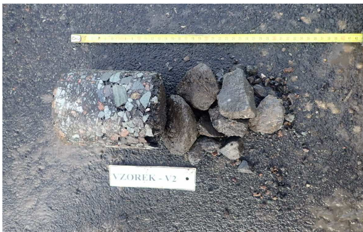
Obr. 3 - Jádro vývrtu Vzorek – V2 (in situ).
