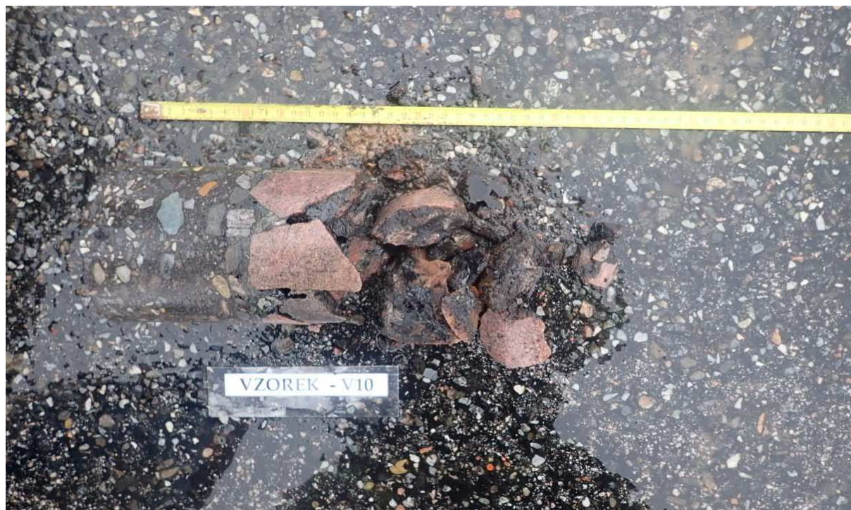
Obr. 19 - Jádro vývrtu Vzorek – V10 (in situ).
