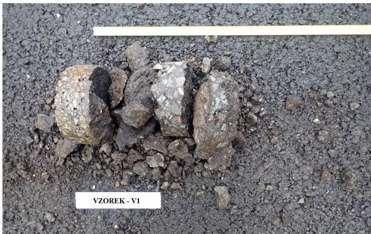
Obr. 1 - Jádro vývrtu Vzorek – V1 (in situ).
