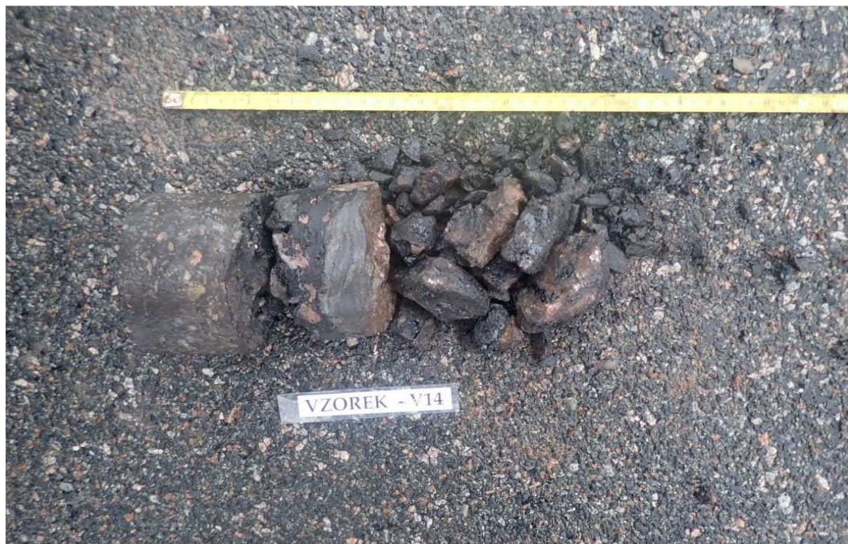
Obr. 27 - Jádro vývrtu Vzorek – V14 (in situ).
