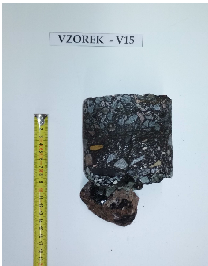
Obr. 30 - Jádru vývrtnu Vzorek – V15 (laboratoř).
