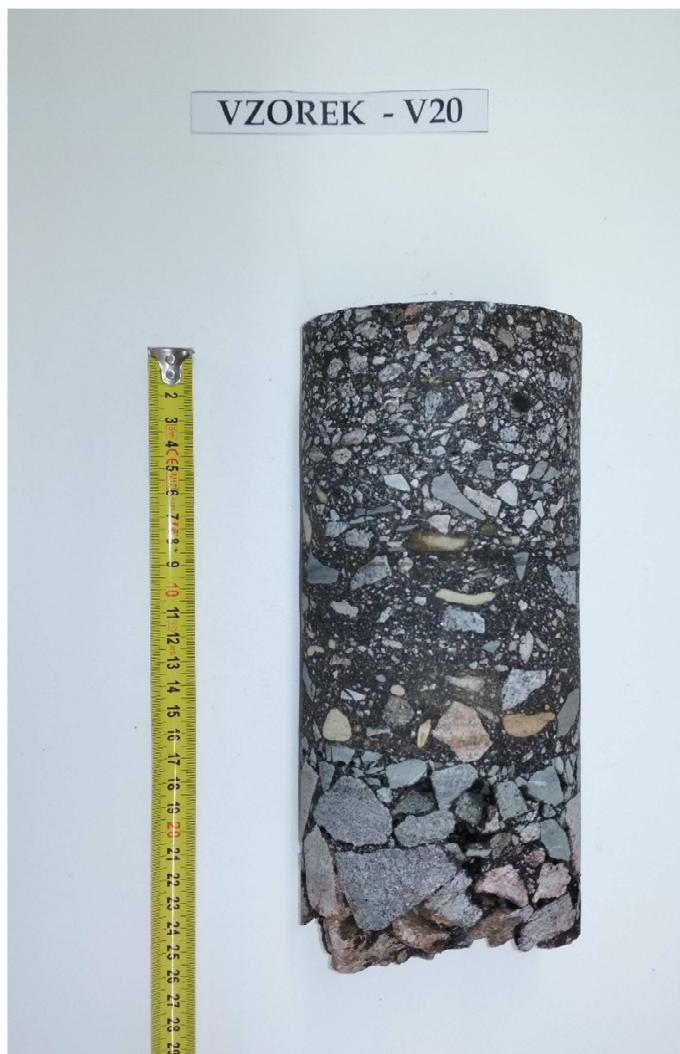
Obr. 40 - Jádru vývrtu Vzorek – V20 (laboratoř).
