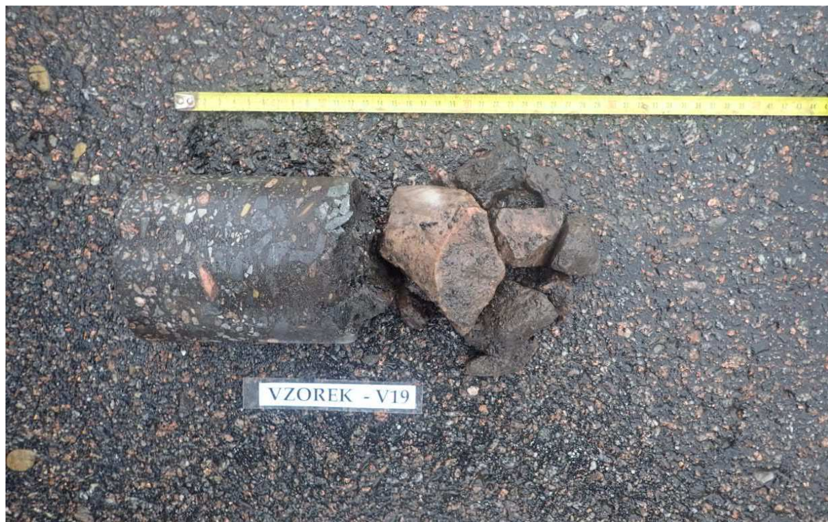
Obr. 37 - Jádro vývrtu Vzorek – V19 (in situ).
