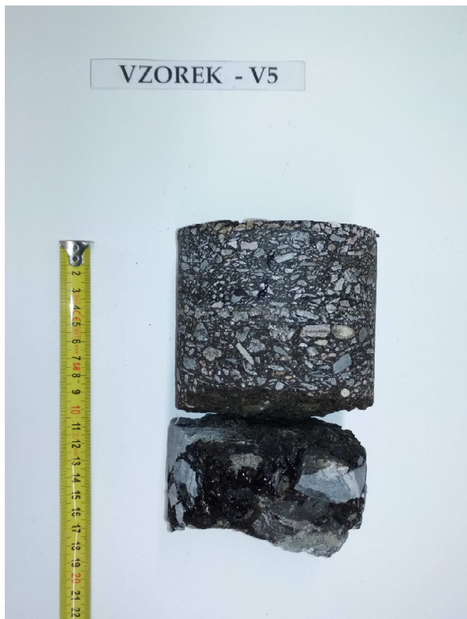
Obr. 10 - Jádro vývrtu Vzorek – V5 (laboratoř).
