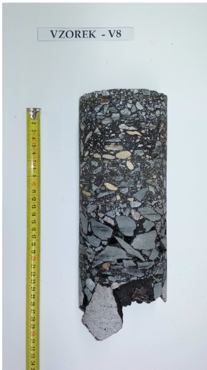
Obr. 16 - Jádro vývrtu Vzorek – V8 (laboratoř).
