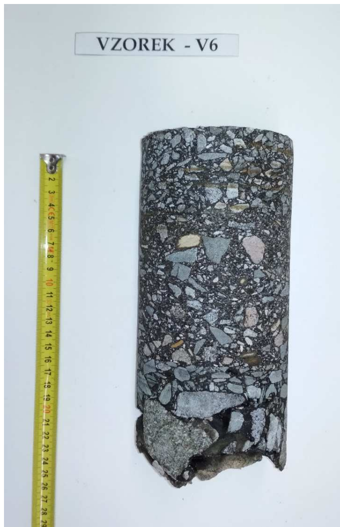
Obr. 12 - Jádro vývrtu Vzorek – V6 (laboratoř).
