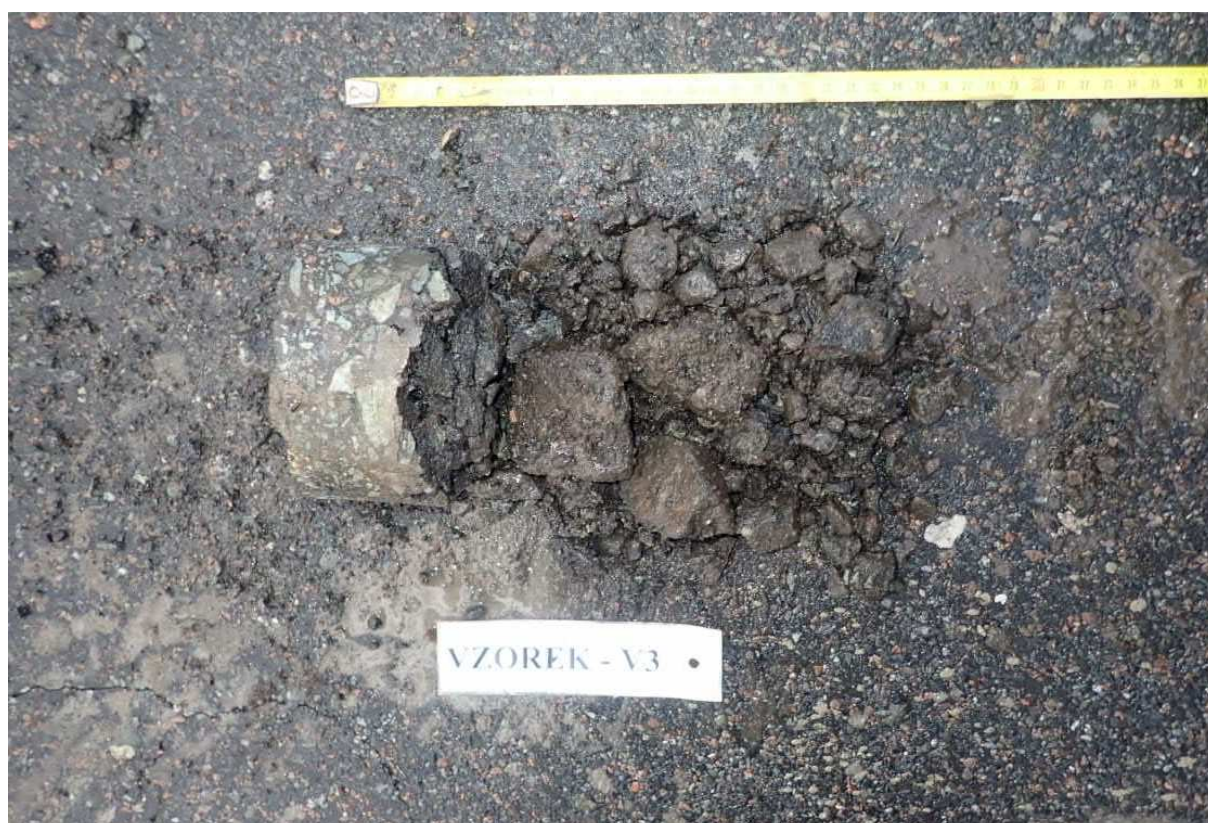
Obr. 5 - Jádro vývrtu Vzorek – V3 (in situ).
