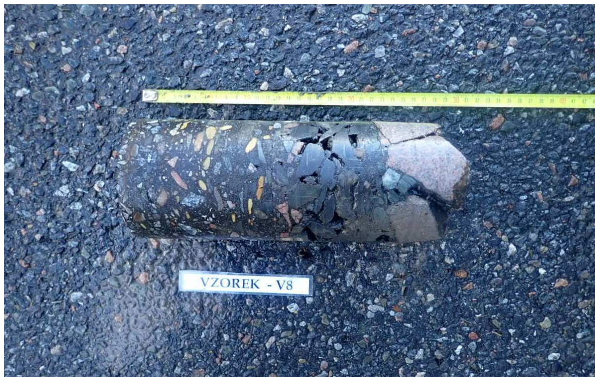
Obr. 15 - Jádro vývrtu Vzorek – V8 (in situ).
