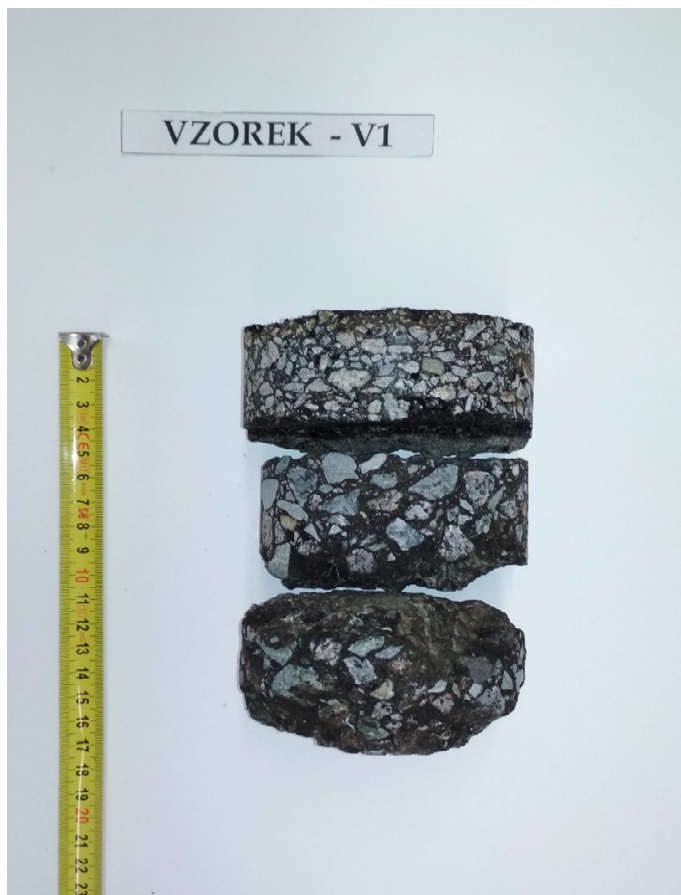
Obr. 2 - Jádru vývrtu Vzorek – V1 (laboratoř).
