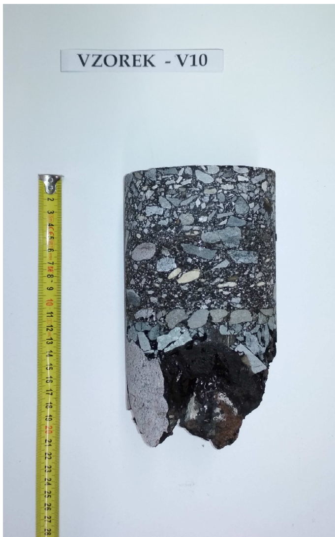
Obr. 20 - Jádru vývrtu Vzorek – V10 (laboratoř).
