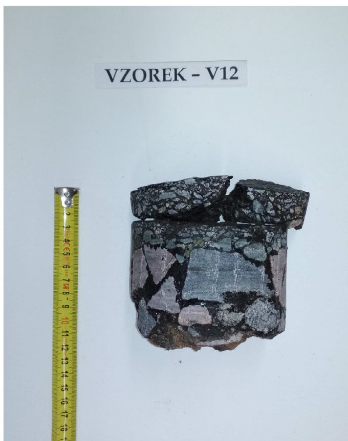
Obr. 24 - Jádru vývrtu Vzorek – V12 (laboratoř).
