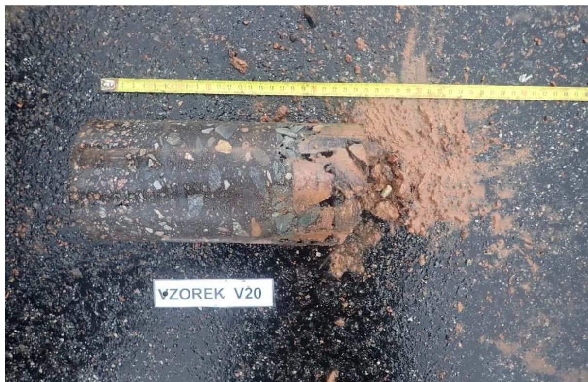
Obr. 39 - Jádro vývrtu Vzorek – V20 (in situ).
