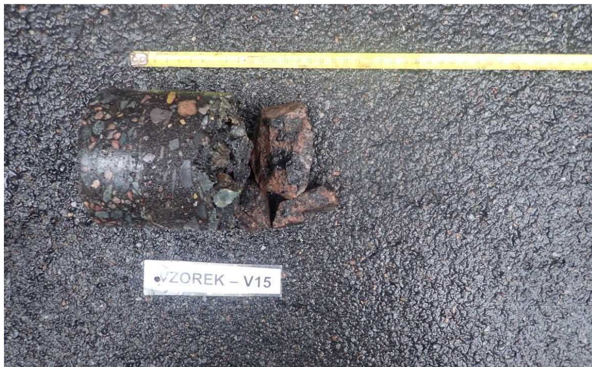
Obr. 29 - Jádro vývrtu Vzorek – V15 (in situ).
