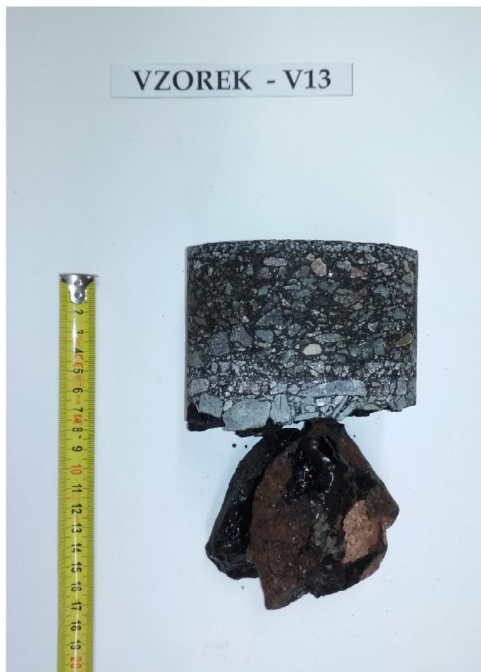
Obr. 26 - Jádro vývrtu Vzorek – V13 (laboratoř).
