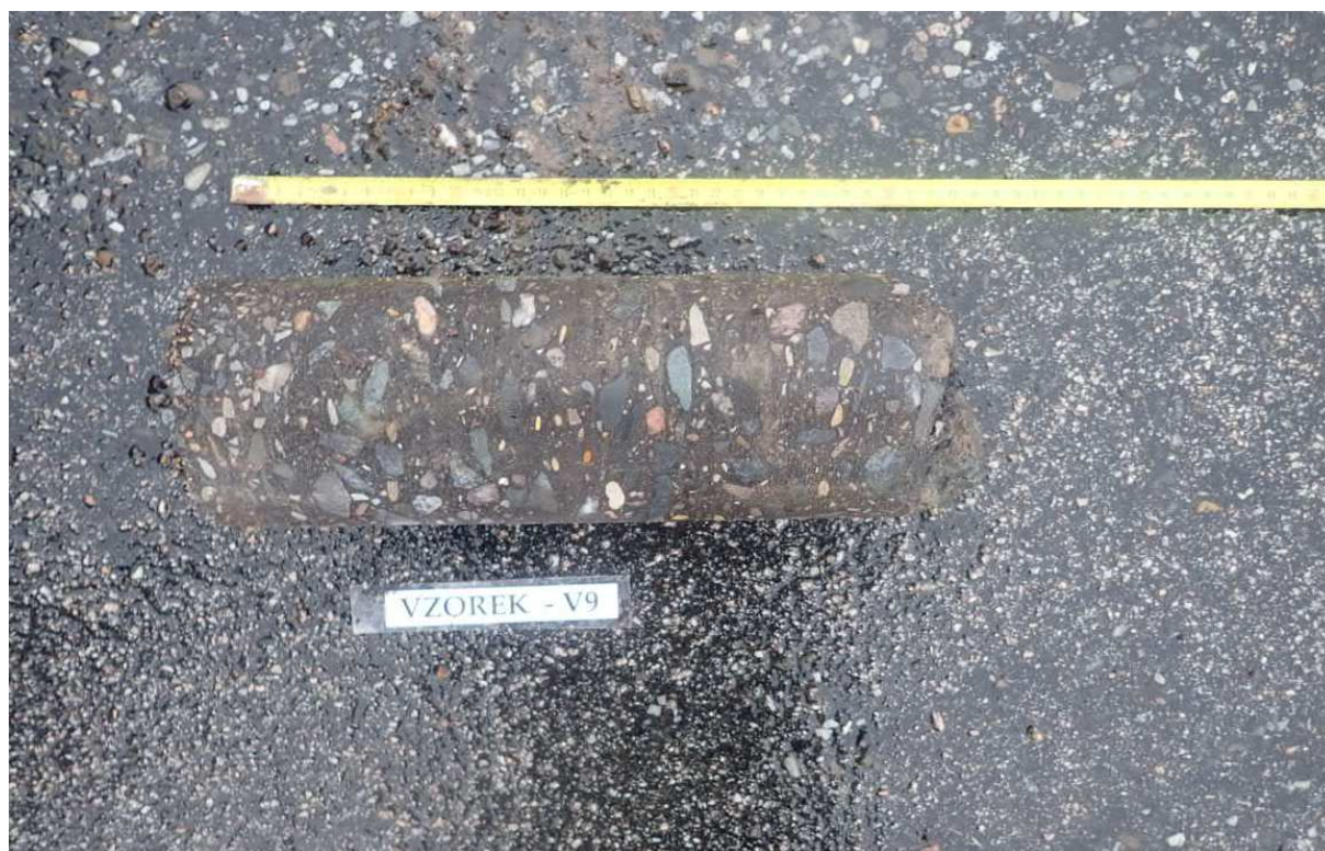
Obr. 17 - Jádro vývrtu Vzorek – V9 (in situ).
