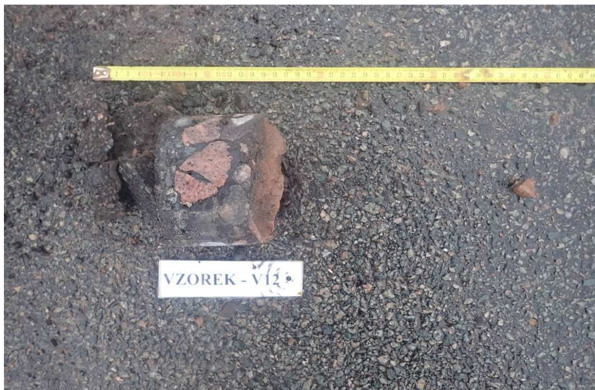
Obr. 23 - Jádro výtvetu Vzorek – V12 (in situ).
